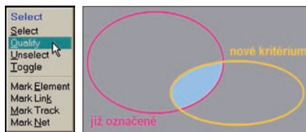
Obr. 2 Příkaz Select / Qualify označené prvky omezí novým kritériem
