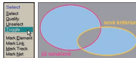
Obr. 4 Příkaz Select / Toggle obrátí označení prvků splňujících kritérium
